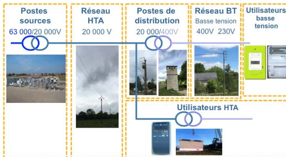
Figure 1 - Rappel des grands ouvrages du réseau électrique. Source : Hespul
