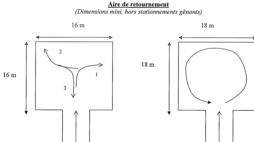
Dans le cas où une aire de retournement ne peut pas être aménagée, une aire de manœuvre en T doit être prévue. Les dimensions minimales de cette aire de manœuvre en T sont présentées dans le schéma ci-dessous.
